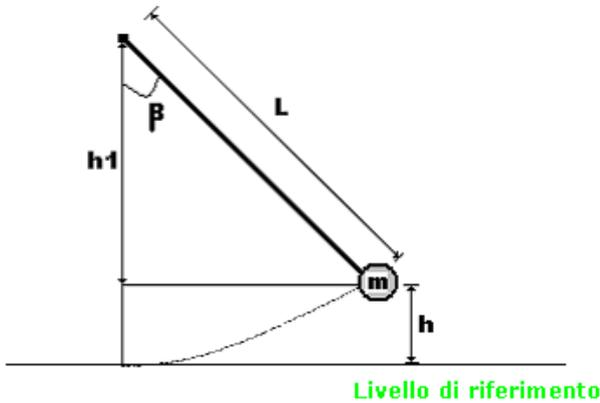
Un'asticella di massa trascurabile e lunghezza  $L = 2,00\text{m}$  è fissata ad un perno che le consente di descrivere un cerchio in un piano verticale. Una palla pesante di massa  $m$  è fissata all'estremità inferiore. L'asticella è spostata lateralmente di un angolo  $\beta = 30^\circ$  e qui viene lasciata libera. A che velocità si muoverà la palla passando per il punto più basso?
