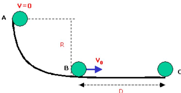
Un corpo di massa  $m = 1 \text{ kg}$  viene lasciato andare, con velocità iniziale nulla nel punto A di una superficie avente la forma di un quadrante di cerchio, di raggio  $R = 1,3 \text{ m}$ . Esso scivola lungo la curva e raggiunge il punto B con una velocità  $V_0 = 3,7 \text{ m/s}$ . A partire dal punto B scivola su una superficie piana, arrestandosi infine nel punto C, che dista  $d = 2,8 \text{ m}$  da B. Calcolare:
